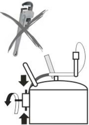
METTRE LE BOUCHON, EN VERIFIANT QUE LE JOINT DE GOMME SOIT PRESSIONNE ENTRE LE BOUCHON ET L'EMBOUCHURE DU RESERVOIR ET QUE LE BOUCHON ET L'EMBOUCHURE DU RESERVOIR S'AJUSTENT DANS LES RAINURES DU FILETAGE
