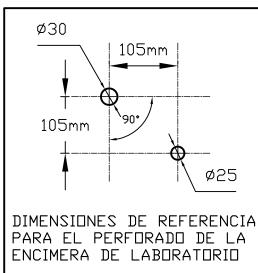
LAS DIMENSIONES AQUI MARCADAS PUEDEN VARIAR EN OBRA +/-10mm MANGUERAS DE CONEXION NO PROVISTAS
