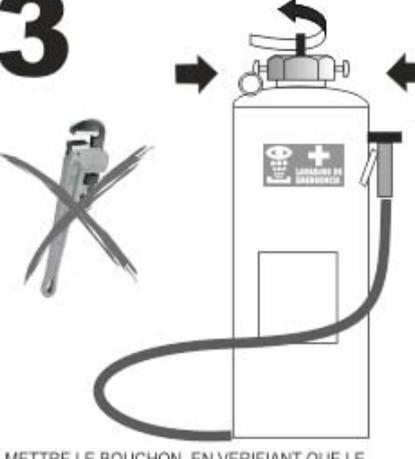
METTRE LE BOUCHON, EN VERIFIANT QUE LE JOINT DE GOMME SOIT PRESSIONNE ENTRE LE BOUCHON ET L'EMBOUCHURE DU RESERVOIR ET QUE LE BOUCHON ET L'EMBOUCHURE DU RESERVOIR S'AJUSTENT DANS LES RAINURES DU FILETAGE
